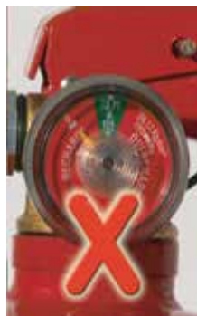
รูปที่ 2 เข็มอยู่ในช่องพื้นที่ "สีแดง" ด้านซ้ายหรือขวา แสดงว่า "เครื่องดับเพลิงอยู่ในสภาพชำรุด" ต้องรีบทำการบรรจุน้ำยาดับเพลิงใหม่ทันที
