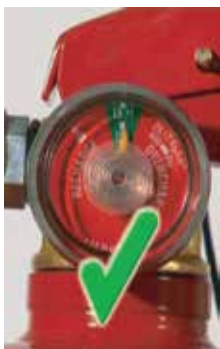
รูปที่ 1 เข็มอยู่ในช่องพื้นที่ "สีเขียว" แสดงว่า "เครื่องดับเพลิงอยู่ในสภาพปกติ" พร้อมใช้งาน
